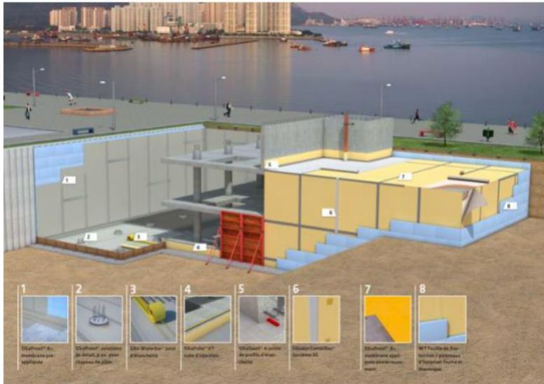
Figure 6: Principe "membrane"
